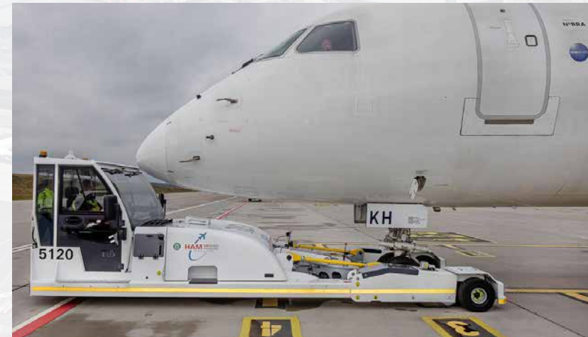
Ungewöhnlicher Kraftprotz mit Elektroantrieb: Der neueste Flugzeugschlepper am Hamburg Airport läuft mit umweltfreundlichem Antriebssystem
