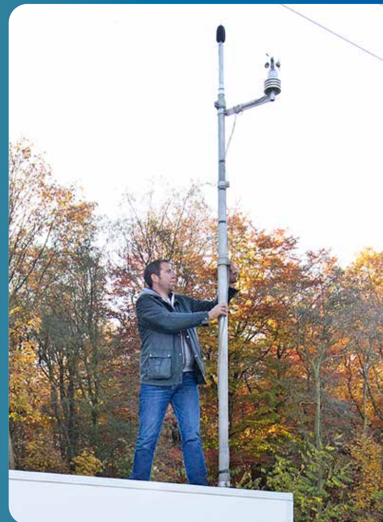
Eine der 14 fest installierten Lärmmessstellen des Flughafens
